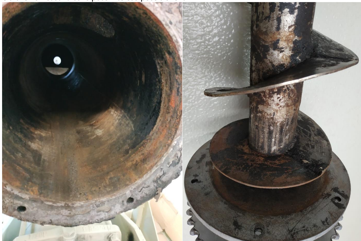
Obrázek 6.: Část válcové pece – těleso pece a šneku
