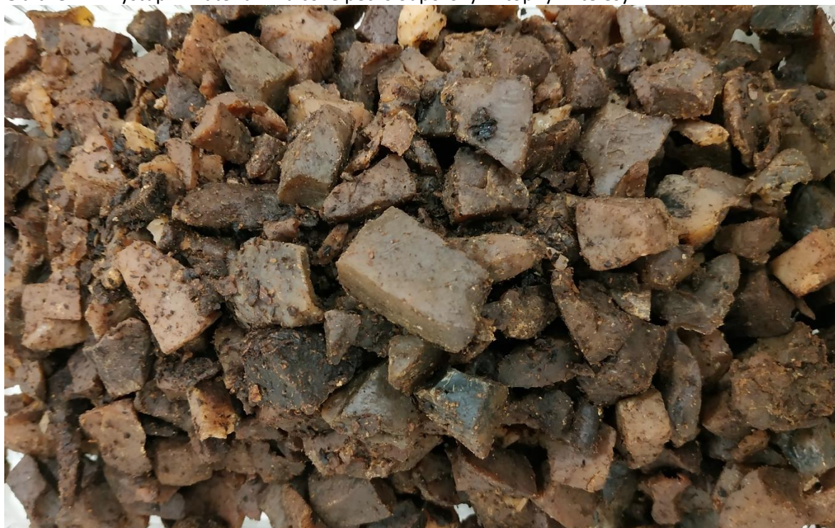
Obrázek 4.: Výstupní materiál z válcové peci s odporovými topnými tělesy
