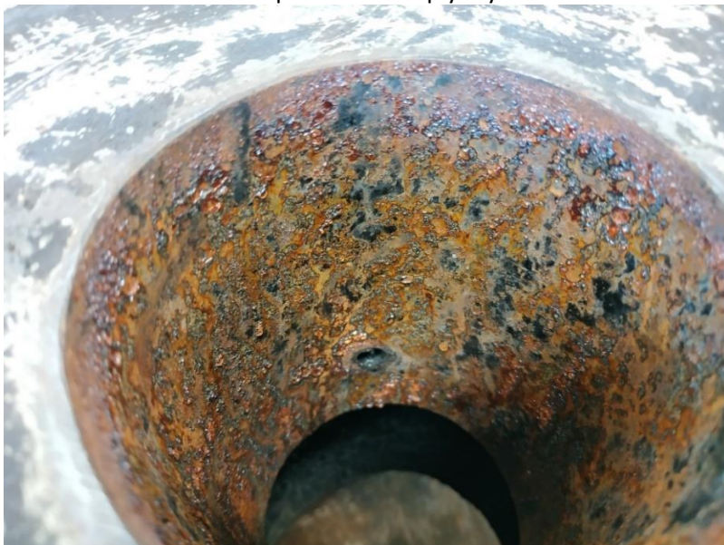
Obrázek 5.: Část válcové pece – odvod plynných složek
